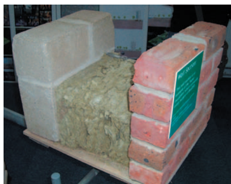
Rys. 2.4. Przekrój przez bardzo mocno izolowaną ścianę zewnętrzną, z zewnętrzną warstwą z ciężkiego betonu w celu uzyskania dobrej masy termicznej. Daje to znakomitą charakterystykę termiczną przez cały rok, poprzez stworzenie zoptymalizowanej kombinacji przepływu i gromadzenia energii. (Zdjęcie zrobione podczas wyjazdu badawczego w BedZED, Wielka Brytania)
